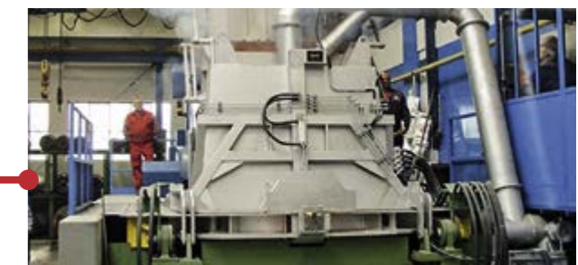
Neuer Elektro-Induktions-Schmelzofen in Andernach
